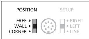
O interruptor POSITION encontra-se no painel de terminais. Nota: É importante que coloque o interruptor SETUP na definição correcta em cada uma das colunas – conforme explicado na página 6.
